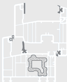
Blendrahmen CLM 30-25 mit Thermlock-Armierung Flügel CZ 31-25 ohne Armierung, für Glasverklebung
